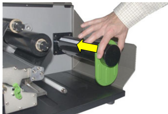
Abb. 4.3.1.d Zweiten Etikettenrollenschutz nach hinten schieben
