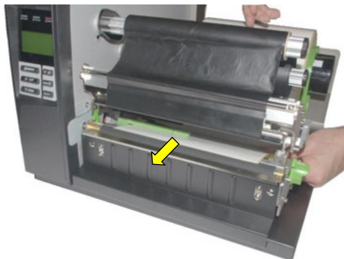
Abb. 4.3.1.l Material nach vorne aus dem Drucker herausführen
