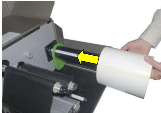
Abb. 4.3.1.f Materialrolle auf den Material-Abwickler schieben und danach mittig ausrichten
