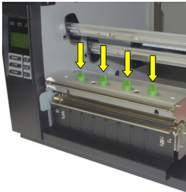
Abb. 4.4.a Druckkopf-Andruck: Position der 4 Drehknöpfe
